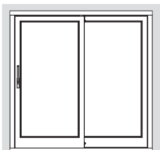
Положение "закрыто": Створка закрыта и заперта
